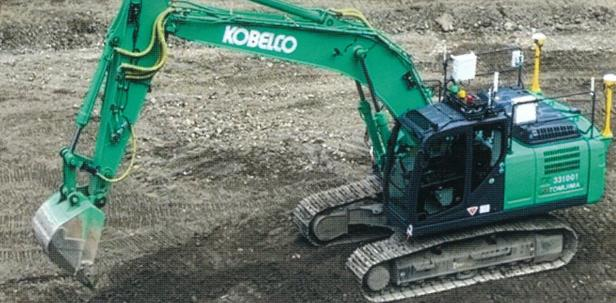
コベルコ建機の現場改善ソリューション「K-DIVE®」が、奈良県五條市内の土砂災害対策工事に導入された。このソリューションは遠隔操作システムと稼働データ活用を2本柱とするもの。施工者のオフィスで本質的な安全性を確保しながら、生産性の向上はもとより、オペレーターの働き方改革まで実現する。
